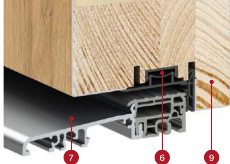
THERMO HOT 88 ajtószárny keresztmetszete takaró tömítéssel és anélkül, alumínium küszöb
