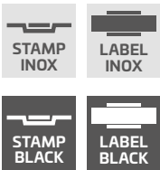
Kétoldalas, 25 mm széles dombornyomás, intarziával, INOX kivitelben vagy fekete festve. Az intarzia az ajtó egyik vagy mindkét oldalára kérhető. Dombornyomott elemek veszik körül és az ajtószárnyal falcolva van (STAMP) vagy lapos ajtószárnyra van ragasztva (LABEL).
